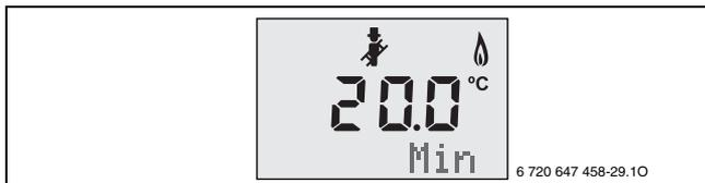
Bild 35 Min (= minimale Nennwärmeleistung) blinkt
