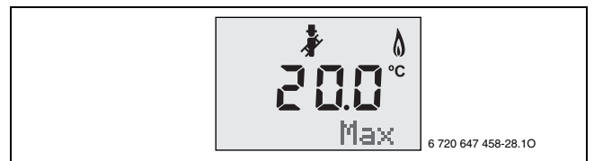
Bild 48 Max (= maximale Nennwärmeleistung) blinkt
