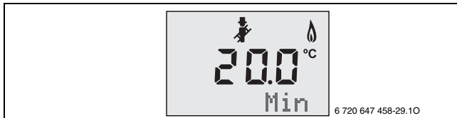
Bild 45 Min (= minimale Nennwärmeleistung) blinkt
