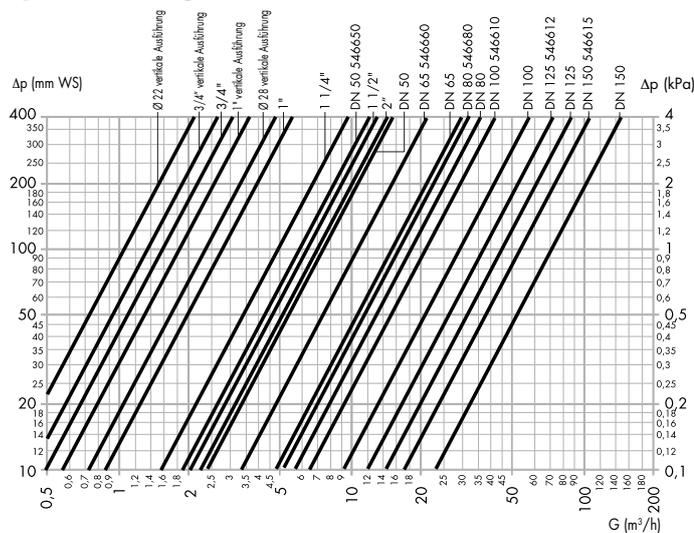
**Die empfohlene Höchstgeschwindigkeit des Mediums an den Anschlüssen des Schlammabscheiders beträgt ~ 1,2 m/s.**
