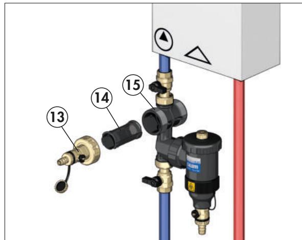
Der Zubehör-Kit für die Kreislaufbefüllung und -spülung (Art.Nr. F49476) besteht aus einem Verschluss mit Entleerungshahn (13) und einem schwarzfarbenen Element (14), das zur Trennung der Ströme in das Gehäuse des Schmutzfängers (15) eingesetzt wird. Dieser Zubehör-Kit kann dazu verwendet werden, eine spezifische externe Maschine zum Füllen und Spülen der Anlage (16) anzuschließen, selbstverständlich unter Beachtung der entsprechenden Vorschriften und Verfahren für die Inbetriebnahme.
