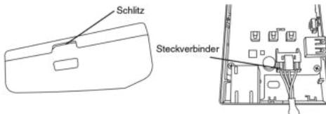
3. Bringen Sie den Adapter an der Wand neben dem Kombi-Hydromodul an, indem Sie die hintere Abdeckung mit Schrauben befestigen.
