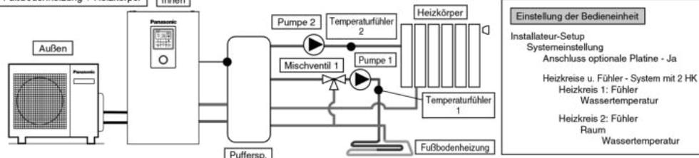
Einen Heizkreis für Fußbodenheizung und einen zweiten Heizkreis für Heizkörper über den Pufferspeicher an das Innengerät anschließen, wie in der Abbildung dargestellt.
