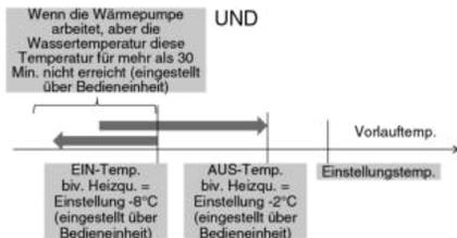
Im Erweiterten Parallelbetrieb ist eine getrennte Einstellung für Pufferspeicher und Warmwasserspeicher möglich. Während des Heiz- und Warmwasserbetriebs wird der Bivalenzausgang bei jeder Umschaltung der Betriebsart auf AUS zurückgesetzt. Für die Auswahl der optimalen Einstellung für das System ist ein gutes Verständnis der Bivalenzfunktion erforderlich.
