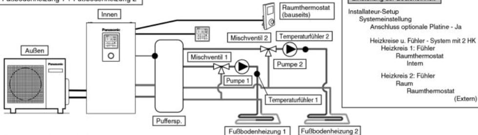
Beide Heizkreise für Fußbodenheizung über den Pufferspeicher an das Innengerät anschließen, wie in der Abbildung dargestellt.
