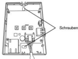
4. Ziehen Sie das CN-CNT-Kabel durch die Öffnung an der Unterseite des Adapters, und bringen Sie die vordere Abdeckung wieder an der hinteren Abdeckung an.
