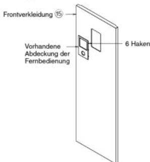
2. Setzen Sie die geschlossene Abdeckung (5) in die Fernbedienungsöffnung ein und drücken Sie sie an, bis die Haken einrasten.
