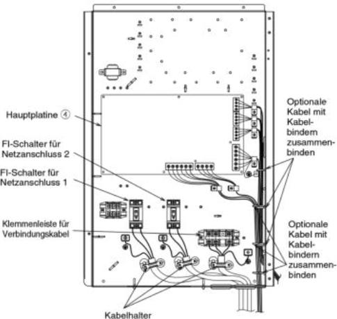
Führung der optionalen Kabel und Netzkabel
