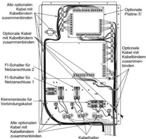
Führung der optionalen Kabel und Netzkabel
