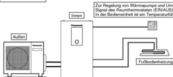
Zur Regelung von Wärmepumpe und Umwälzpumpe empfängt das Kombi-Hydromodul das Signal des Raumthermostaten (EIN/AUS) von der Bedieneinheit. In der Bedieneinheit ist ein Temperaturfühler eingebaut.
