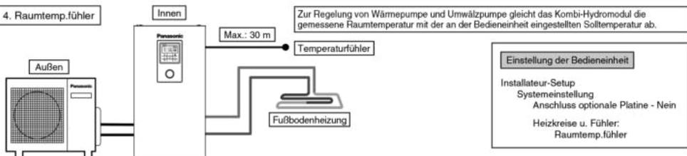
Fußbodenheizung oder Heizkörper direkt an das Kombi-Hydromodul anschließen. Die Bedieneinheit ist am Kombi-Hydromodul montiert. Separaten externen Raumtemperaturfühler (gemäß Spezifikation von Panasonic) in dem Raum mit der installierten Fußbodenheizung montieren. Bei dieser Anwendung wird ein externer Raumtemperaturfühler verwendet.
