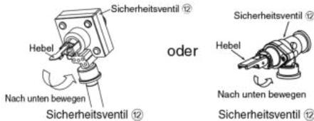
3. Befüllen Sie den Heiz- bzw. Kühlkreis über den Anschluss ⑬ mit Wasser mit einem Druck größer 1 bar. Beenden Sie das Befüllen, sobald Wasser aus dem Ablauf des Sicherheitsventils ⑫ austritt.
