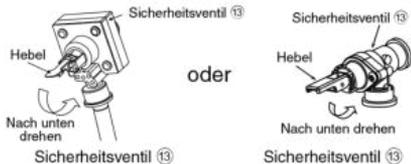
3. Das Innengerät über den Wassereintritt mit Wasser (mit einem Druck größer als 0,1 MPa (1 bar)) befüllen beginnen. Das Befüllen, sobald Wasser aus dem Ablaufschlauch des Sicherheitsventils austritt, beenden.
