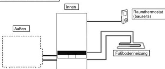
Fußbodenheizung oder Heizkörper direkt an das Innengerät anschließen.
