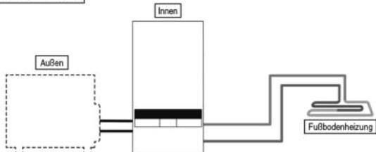
Fußbodenheizung oder Heizkörper direkt an das Innengerät anschließen. Bedieneinheit ist am Innengerät montiert.
