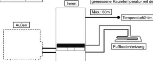
Zur Regelung von Wärmepumpe und Umwälzpumpe gleicht das Innengerät die gemessene Raumtemperatur mit der an der Bedieneinheit eingestellten Solltemperatur ab.
