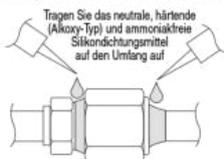
Das neutrale, härtende (Alkoxy-Typ) und ammoniakfreie Silikonkonditionierungsmittel wird erst nach dem Drucktest und Reinigen und nur auf die Außenseite des Anschlusses unter Beachtung der folgenden Anweisungen angebracht. Ziel ist es, dass keine Feuchtigkeit in die Fugenverbindung gelangt und dass vor Frost geschützt wird. Das Härten des Dichtungsmittels wird etwas Zeit in Anspruch nehmen. Stellen Sie sicher, dass sich das Dichtungsmittel beim Isolieren nicht abtötet.
