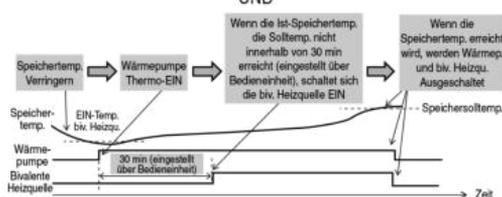
Bivalente Heizquelle Im Erweiterten Parallelbetrieb ist eine getrennte Einstellung für Pufferspeicher und Warmwasserspeicher möglich. Während des Heiz- und Warmwasserbetriebs („HEAT+TANK“) wird der Bivalenzausgang bei jeder Umschaltung der Betriebsart auf AUS zurückgesetzt. Für die Auswahl der optimalen Einstellung für das System ist ein gutes Verständnis der der Bivalenzfunktion erforderlich.
