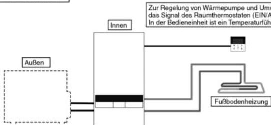
Zur Regelung von Wärmepumpe und Umwälzpumpe empfängt das Innengerät das Signal des Raumthermostaten (EIN/AUS) von der Bedieneinheit. In der Bedieneinheit ist ein Temperaturfühler eingebaut.
