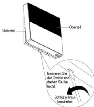
3. Die Schritte 1 bis 4 aus dem Abschnitt „Entfernen Sie die Fernbedienung vom Innengerät“ umkehren, um das Gehäuse der Bedieneinheit ⑦ am Innengerät zu befestigen.
