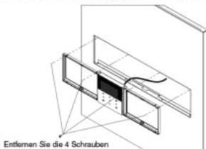
Entfernen Sie die 4 Schrauben
