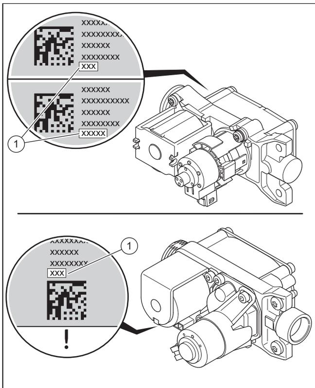
1. Lesen Sie den aufgedruckten Offset **(1)** von der Rückseite bzw. von der Unterseite der Gasarmatur ab. Verwenden Sie z. B. einen Spiegel.
