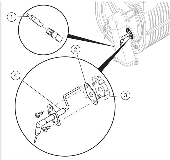
1. Ziehen Sie den Stecker (1) des Kabels der Regelungselektrode ab.
