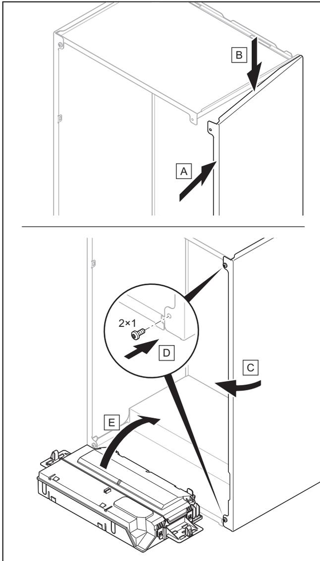
1. Wenn Sie die Seitenverkleidung demontiert haben, dann montieren Sie die Seitenverkleidung, wie in der Abbildung dargestellt.
